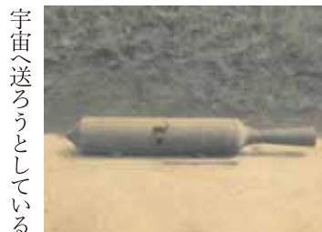
▲有人特攻機「桜花」のロケットエンジン写真。直徑11cmのダブルベース火薬が6本束ねられ、戦後にカッパ1型やカッパ4型ロケットでも同じ火薬が使われた。（増田和之氏寄贈）
